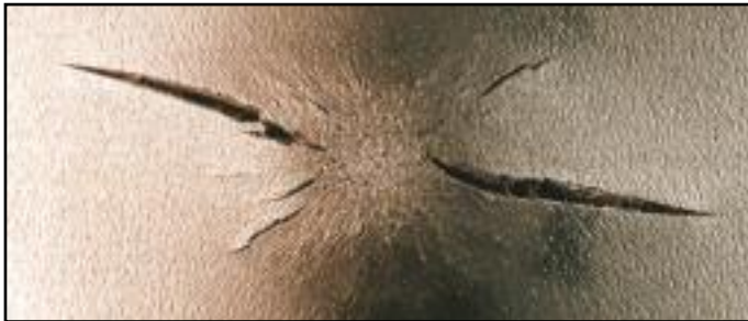
Fig. 7 - Test di resistenza ai carichi concentrati: superficie interna.
